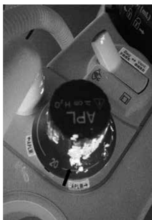
図4 APLバルブの汚染
